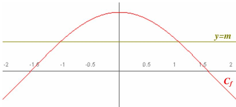
Les solutions de l'équation  $f(x) = m$  sont les abscisses des points d'intersection de  $C_f$  avec la droite d'équation  $y = m$ .
